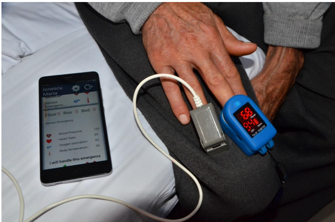
Fig. 26. Transmiterea parametrilor fiziologici telemonitorizați (ritmul cardiac, saturația oxigenului în sânge și temperatura) la dispozitivul Supraveghetorului (a, b)
