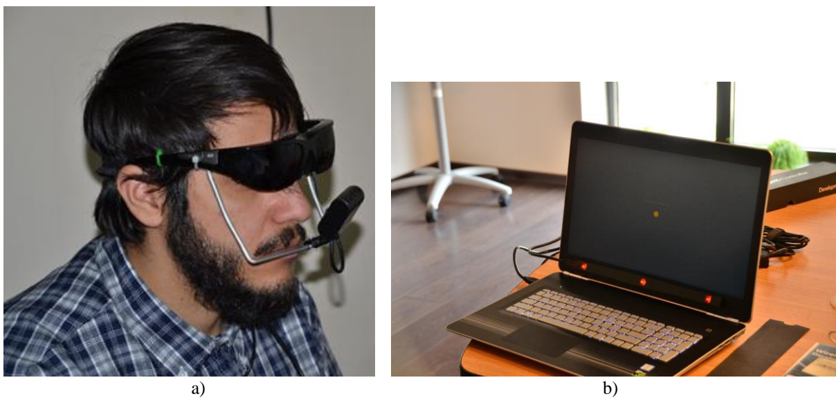
Fig. 2. a) Dispozitiv pentru detecția privirii cu montare pe cap (cameră video în infraroșu montată pe o ramă de ochelari); b) Dispozitiv pentru detecția privirii „remote” (senzor infraroșu plasat pe laptop-ul pacientului)
