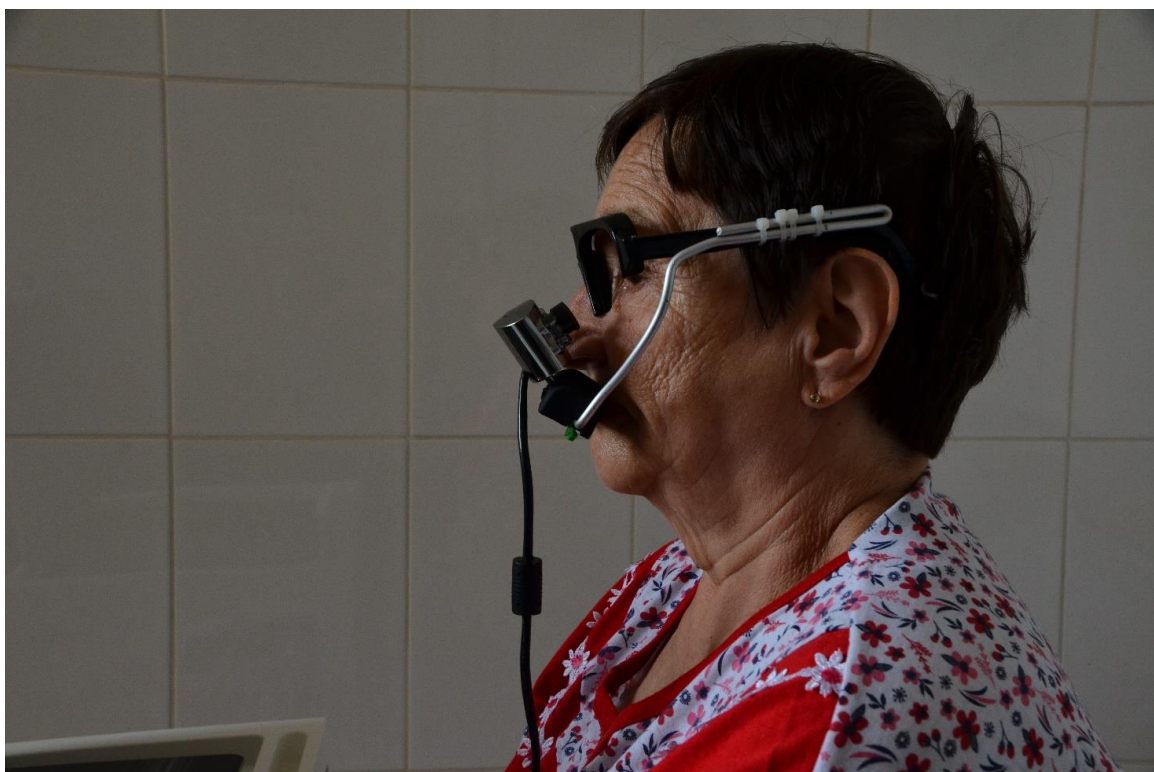
Fig. 21. Testarea în Spital a componentei de comunicare prin detecția privirii cu ajutorul unui dispozitiv „eye tracking” cu montare pe cap a modelului experimental SIACT
