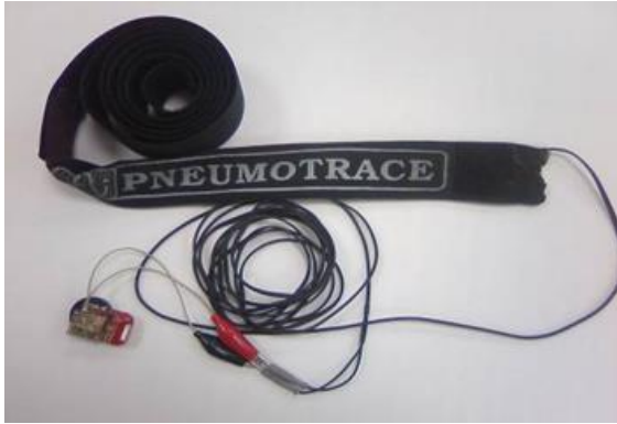
Fig. 5. Dispozitivul pentru telemonitorizarea ritmului respirator
