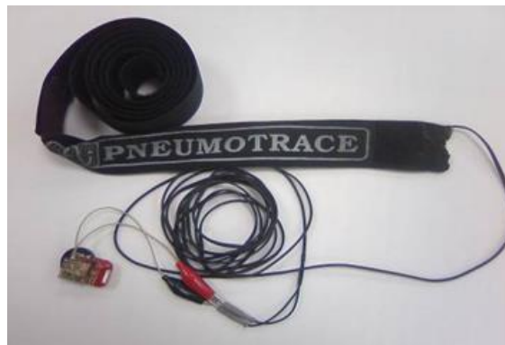
Fig. 4. Dispozitivul pentru telemonitorizarea ritmului respirator
