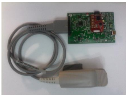
Fig. 3. Dispozitivul pentru telemonitorizarea ritmului cardiac și a saturației O 2
