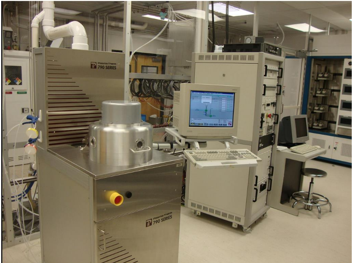
Fig.3 Instalație de corodare cu ioni reactivi într-o cameră curată de laborator
