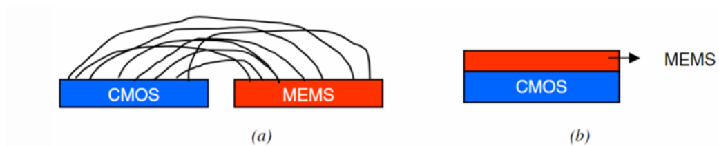
Fig.7 : Integrarea actuala (a) și perspectiva de integrare (b) dintre substratul CMOS și MEMS
